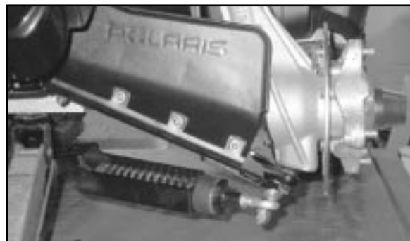
Figure 7 - Installation de l'anti-rotation avant (étape 6.6)
