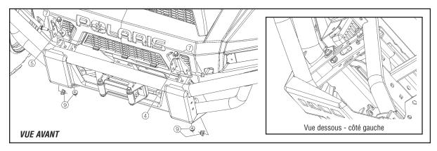
2. Positionner et fixer la section centrale du pare-chocs avant ① aux supports gauche ④ et droit ⑤ installés à l'étape 1 à l'aide de (4) boulons hex. à épaulement M8-1.25 X 20 mm ⑦ et de (4) écrous à épaulement autobloquants M8-1.25 ⑨ (visser les premiers filets seulement).
